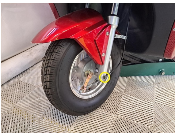
Irrota etuakseli (kiintoavain 14 mm) vastamutteri. (kiintoavain 17 mm).
