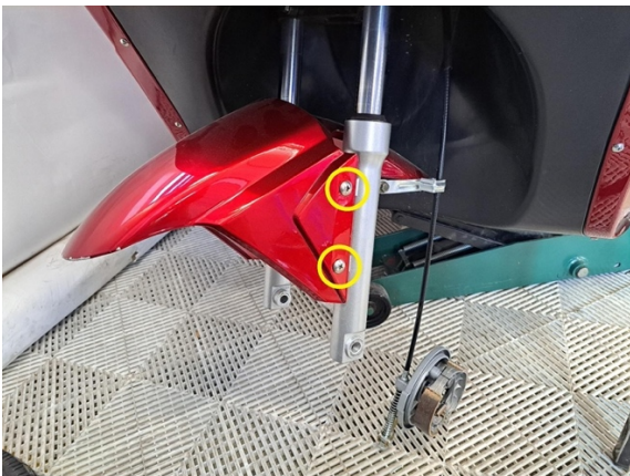
Irrota etulokasuojan kiinnityspultit kummaltakin puolelta. (ristipäämeisseli ph2).
