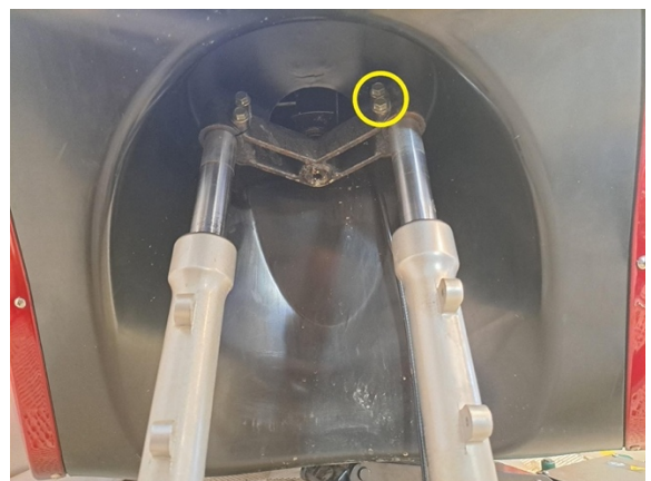
Löysää vasemman etujousen kiinnityspultit. (kiintoavain 12 mm).
