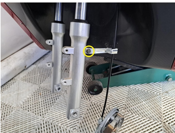
Irrota etujarruvaijerin kiinnikkeen kiinnityspultti. (kiintoavain 10 mm).
