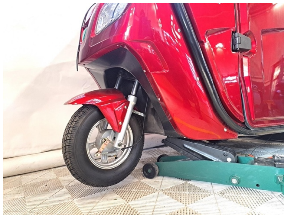
Nosta Autokruiserin etuosa ilmaan. (tunkki).
